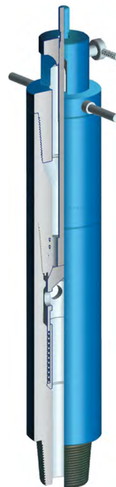
Inside BOP (F01)
